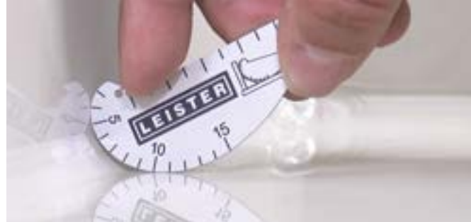
Удобно контролировать размер сварочного шва
